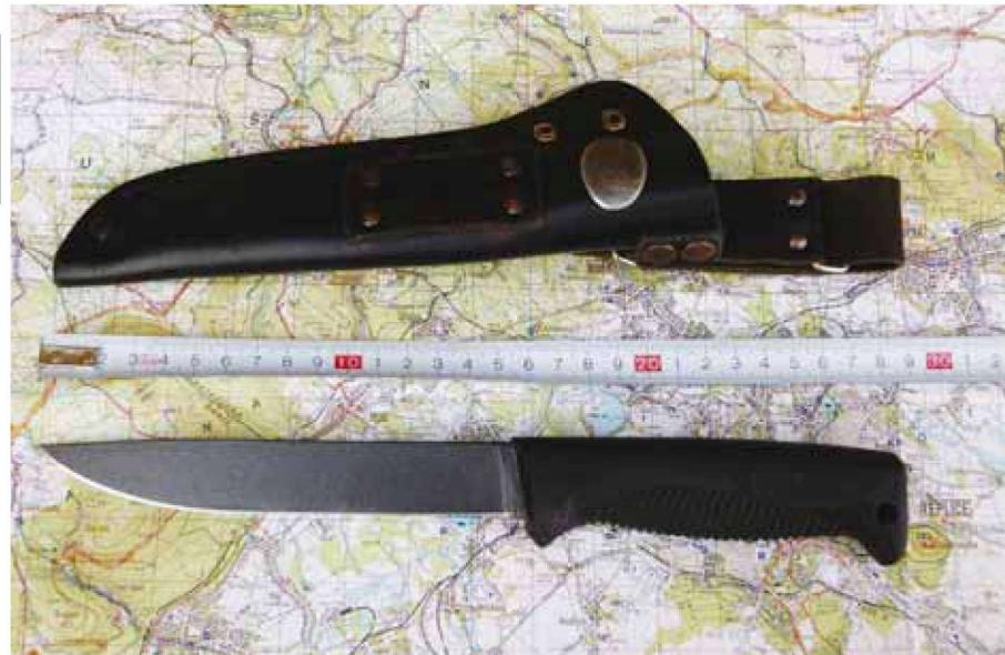
lice odolný teflonový povlak. Pozornost zasluhuje i pouzdro nože. Je kožené s plastovou vložkou uvnitř a nůž uvnitř pouzdra je držen gumovým kolečkem. Při zasunutí do pouzdra se kolečko přetočí přes výstupek v dolní části rukojeti u čepele. Při vytážení si obvykle pomáhám opřením palce o plastový výstupek na hřbetní části pouzdra. Pouzdro lze uchytit na opasek či batoh několika způsoby díky závesnému očku a průvlaku.
