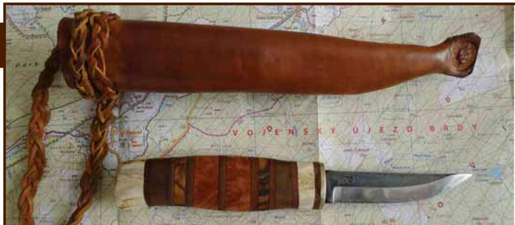
Rukojet je ošetřena povařením ve směsi olivového oleje a včelího vosku. Pouzdro nože je toulcové, skandinávského typu z hovězí kůže namořené lihovým mořidlem a ošetřené přípravkem s včelím voskem. Uvnitř pouzdra je vložka proti proříznutí a hlavně propichnutí.
